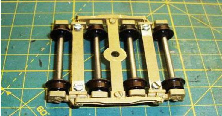
Die Räder, aus Hardkunststoff, können aus das HO Sortiment stammen (US Rader sind breiter) und werden auf neue Achsen geschoben (Stummel 1.2 mm) und laufen in Delrin Gleitlager.
