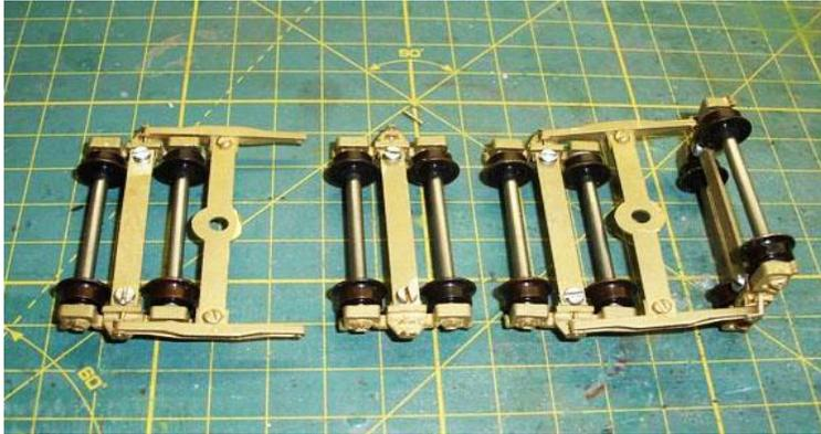
Das 4 Achsiges montierte Drehgestelle werden nach Grundierung und Lackierung endgültig unter den Wagenboden montiert.
