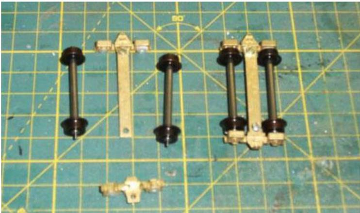
Jedes von die zwei Radstellen wird in die Hauptbrücke montiert mit einem Stift an jede Seite.
