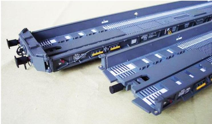
Normalerweise fahren mehrere Wagen, in Zug gekuppelt mit die Niederflerkupplung (unter der Wagenboden) zusammen, und stehen nur die Wagen mit ein Pufferbohle und normale Schraubekupplung am beide Zugenden.
