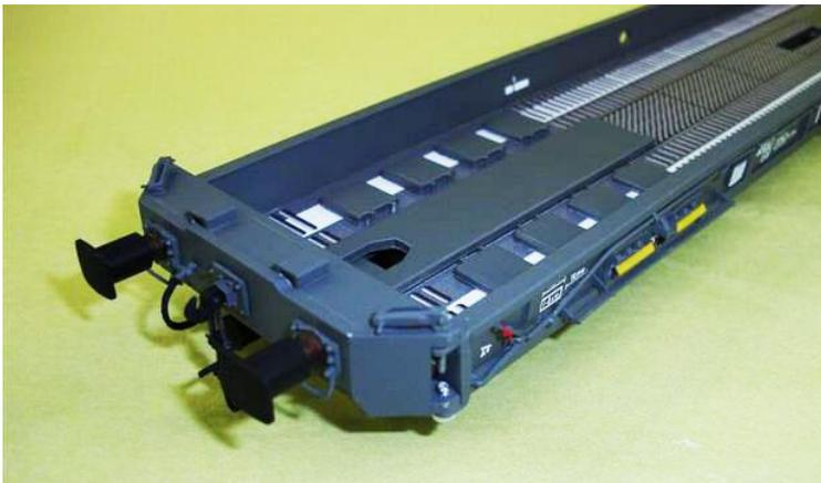
Auch werden die Einzelpuffer montiert und die versenkte Kurzkupplung um die Wagen mit einander zu kupplern.
