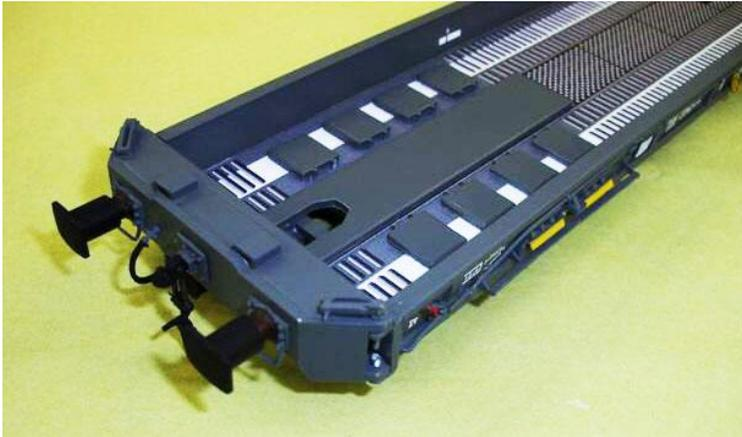
Weiter werden die Puffer auf die Pufferbohle montiert mit die original Schraubkupplung.
